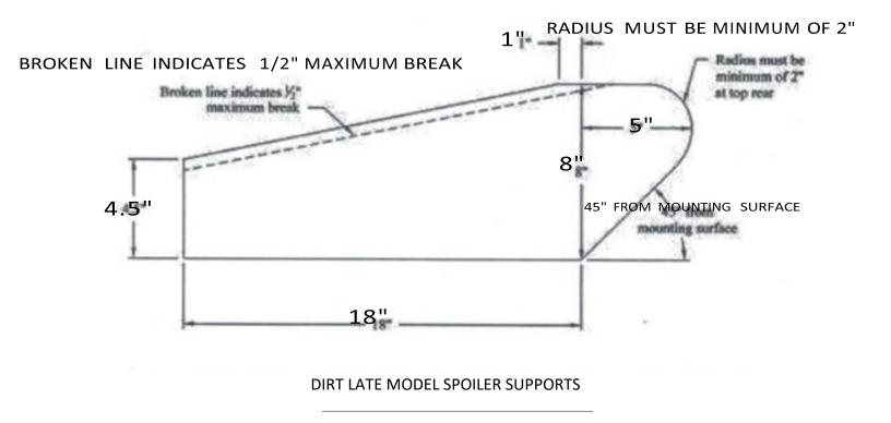
NO MORE THAN THREE (3) SPOILER SUPPORTS PERMITTED. FRONT EDGE OF SUPPORTS MUST BE IN LINE Must match template.
